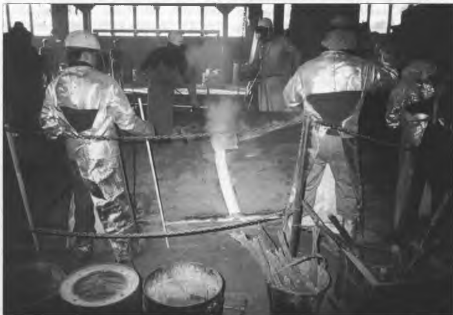
Žehliwa bronza lije so po wuskich hrjebičkach do njewidžomnych hlinjanych zwonowych formow pod zemju. Foto: M. Wirth
